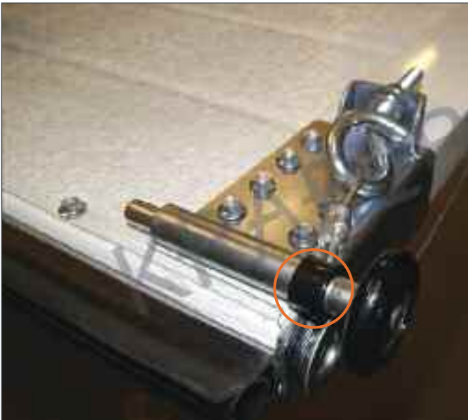
Tre på løpehjul med plastavstandsring 12 mm . Avstandsringen hindrer braketten i å skrape mot skinne. Fest wire som på bildet.
