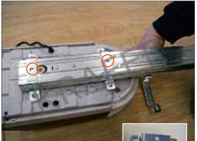
Fest motoren til trekkskinne med braketter. Merk at de med store hull tilhører motoren og den med lite hull er til trekkskinna.
